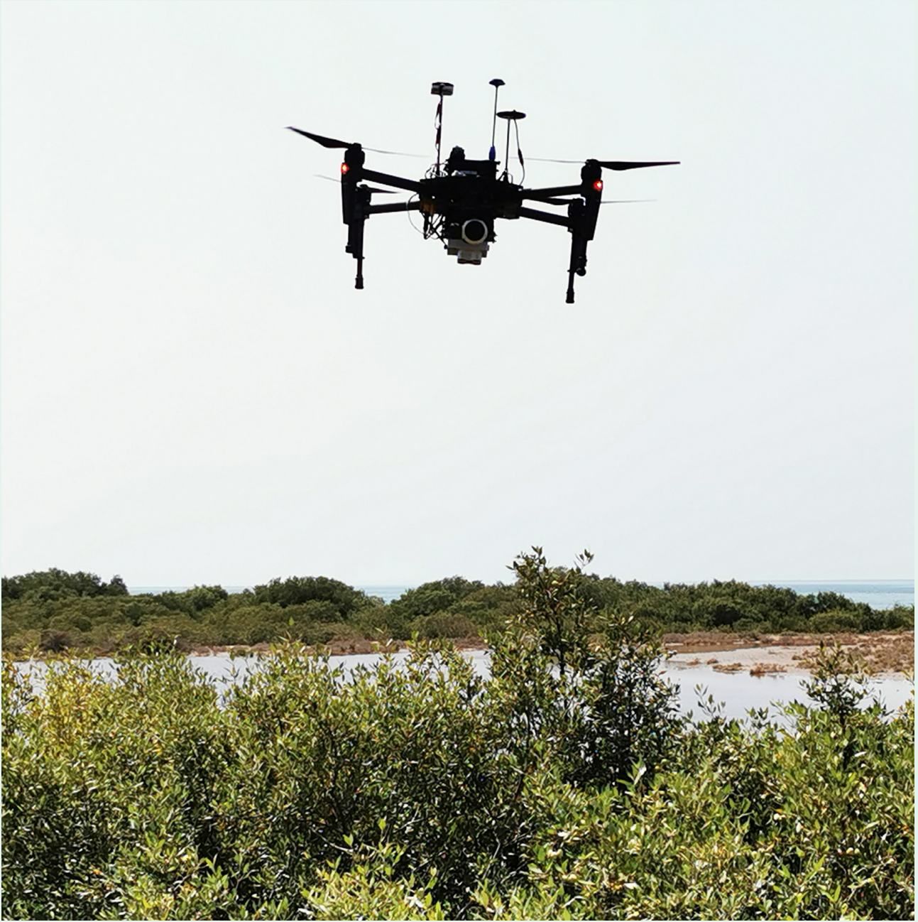
أدوات الاستشعار عن بعد لرسم الخرائط ومراقبة صحة النبات باستخدام الطائرة بدون طيار، جامعة الملك عبدالله للعلوم والتقنية
