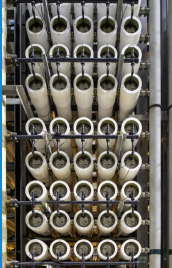
معدات التناضح العكسي داخل محطة لتحلية المياه المالحة، المؤسسة العامة لتحلية المياه المالحة
