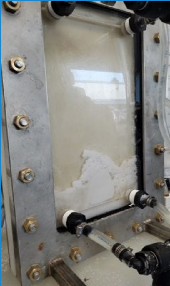
توطين إنتاج الأغشية في شركة نيوم للطاقة والمياه «إينووا» وتطوير غشاء انتقائي لاستخراج المحلول الملحي
