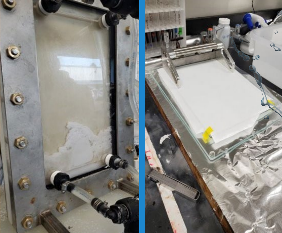
جهاز التبلور الغشائي المتخصص لدى شركة نيوم للطاقة والمياه «إينووا» توطين إنتاج الأغشية في شركة نيوم للطاقة والمياه «إينووا» وتطوير غشاء انتقائي لاستخراج المحلول الملحي
